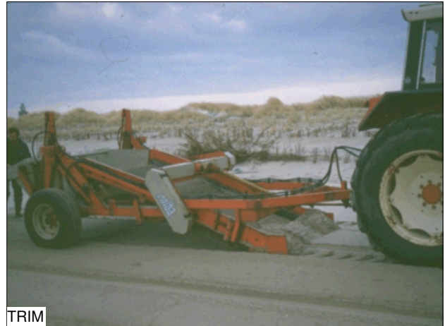
Opruimen teerballen m.b.v. trilzeefwagen
