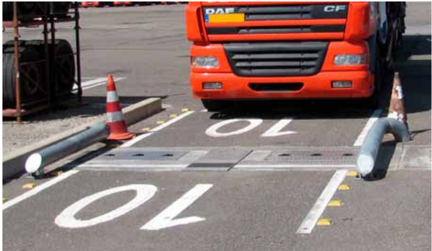
Het bandenspanning meetsysteem, zoals dat bij Combi Terminal Twente in Hengelo wordt toegepast
