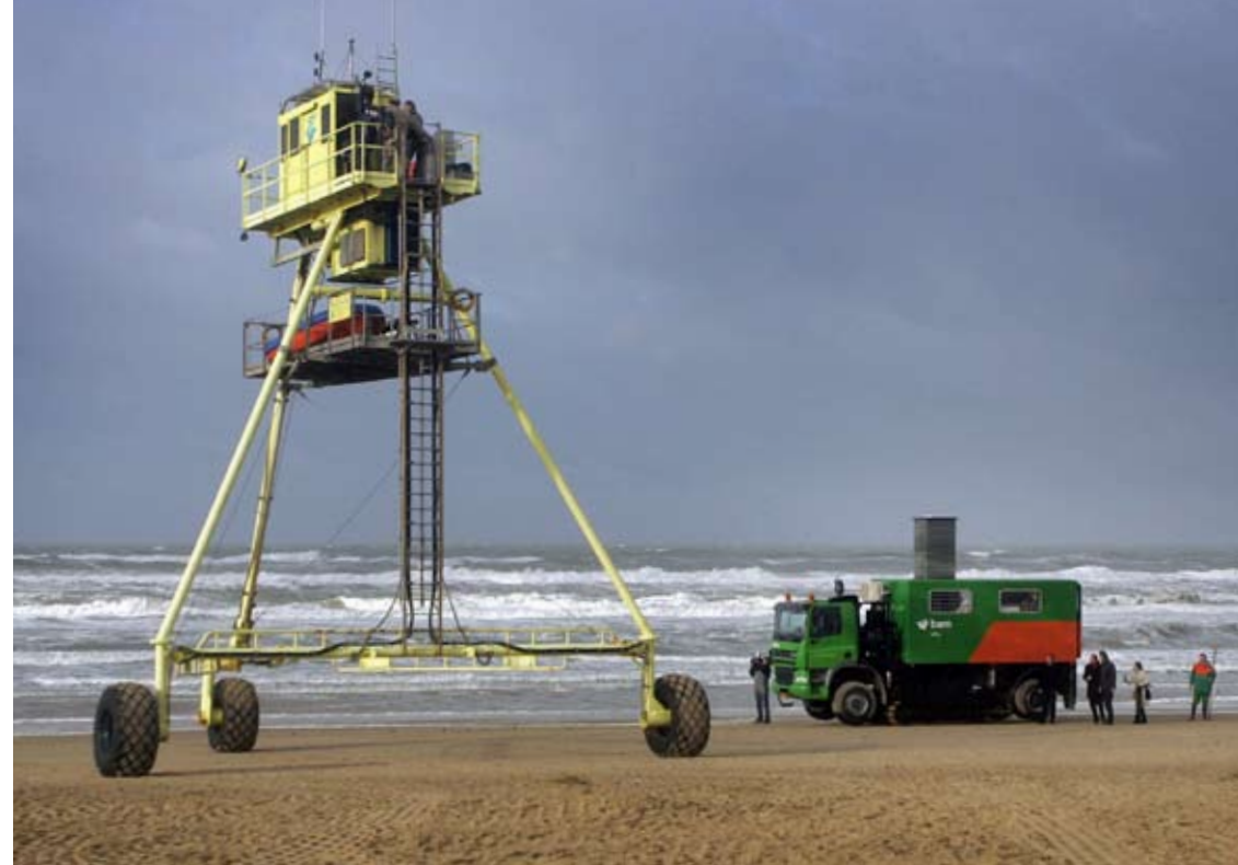
De WESP (Water en Strand Profiler) voert voor Ecobeach metingen uit.
