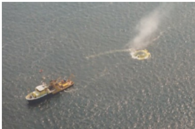
Figuur 29.14 Gaswolk veroorzaakt door het gecontroleerd opblazen van een chloor cilinder
