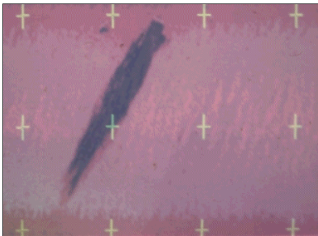
Figuur 24.9 Sidelooking airborne radar opname van een olieverontreiniging
