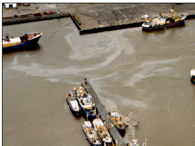
Figuur 22.1 Voor het vaststellen wie de overtreder is dienen van zowel het water als van potentiële lozers een oliemonster te worden genomen en geanalyseerd op overeenkomst
