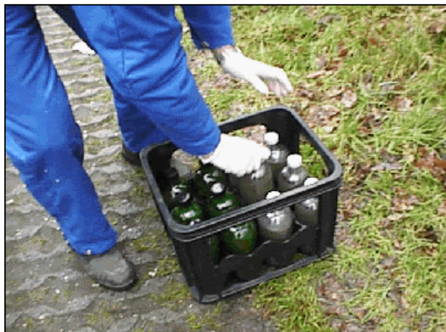
Figuur 22.5 Krat voor veilig vervoer van monsterflessen/potten
