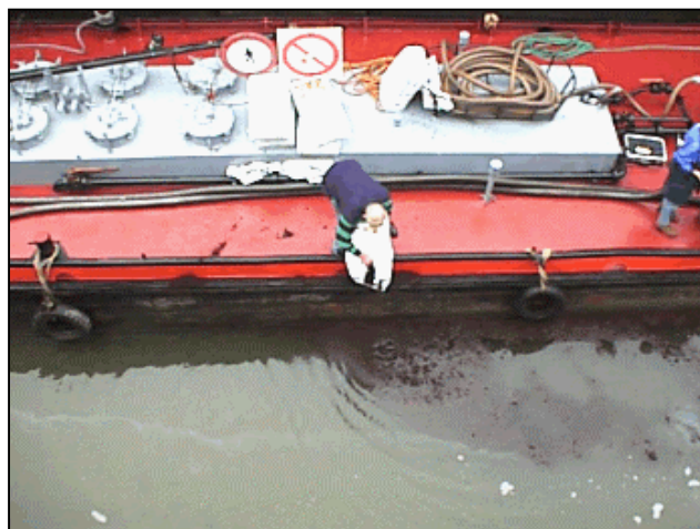
Figuur 20.7 Om bij oefeningen het gedrag van olie op het water te simuleren wordt vaak turf gebruikt.
