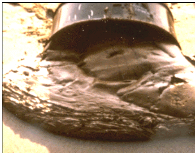
Figuur 20.9 Door emulsievorming neemt zowel de dichtheid als de viscositeit enorm toe.
