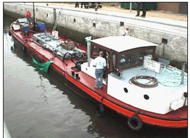
Figuur 16.3 Met een zeil wordt getracht het gat te dichten en de uitstroming van olie te stoppen
