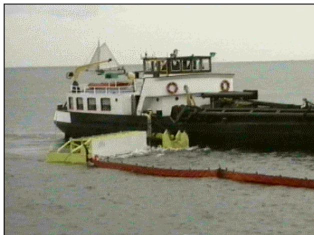
Figuur 16.8 Drijvende olie wordt op open water met veegsystemen verwijderd
