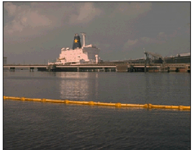
Figuur 16.11 Tegen gaan van de verspreiding op open wateren kan met oliekerende schermen
