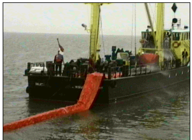
Figuur 16.5 Oliekerende schermen worden ingezet om de uitstromende olie in te dammen
