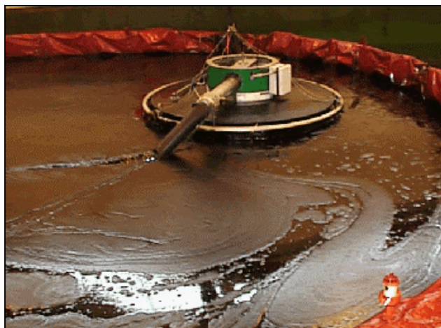
Figuur 16.6 Om op open water olie effectief te kunnen verwijderen moet men de olie eerst concentreren met een oliekerend scherm
