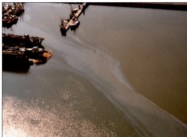
Figuur 14.12 Havens dienen zo snel mogelijk te worden afgesloten om verspreiding van olie te voorkomen
