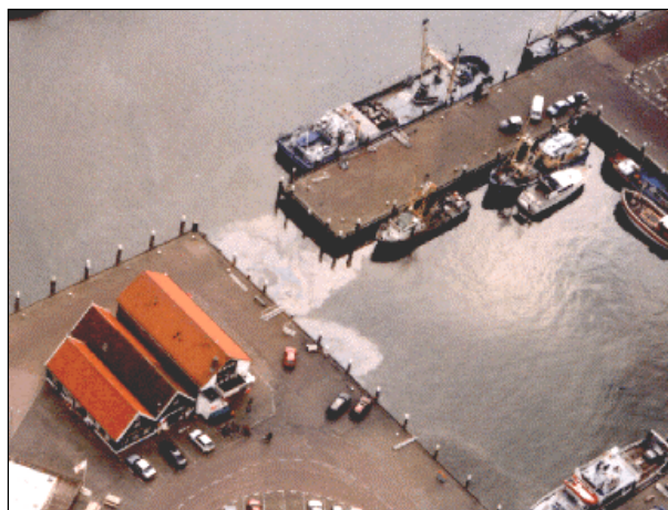
Figuur 13.10 Snel afsluiten met behulp van een oliekerend scherm voorkomt verdere verspreiding van de olieverontreiniging
