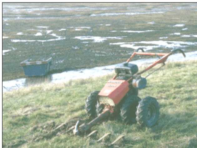
Figuur 13.12 Stokmaaiër om de top vegetatie te verwijderen
