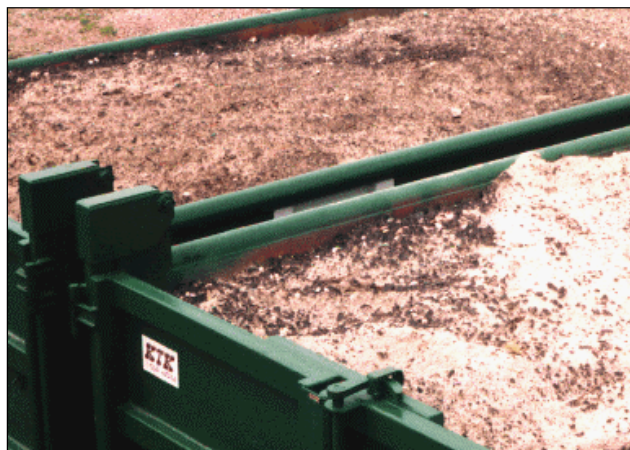
Figuur 12.8 Verzameld zandmengsel met een klein % olie leent zich goed voor uitgloeien
