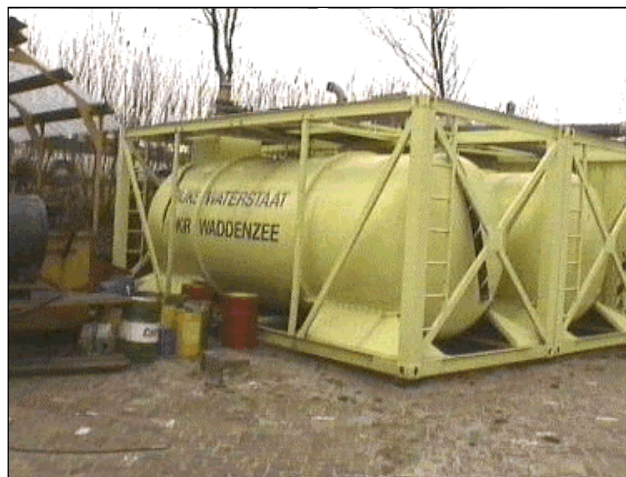
Figuur 12.2 Tankcontainers voor opslag en separatie van olie water mengsels
