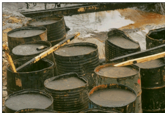
Figuur 12.6 Kleinschalige opslag in vaten is al beter dan in plastic zakken maar nog steeds niet ideaal
