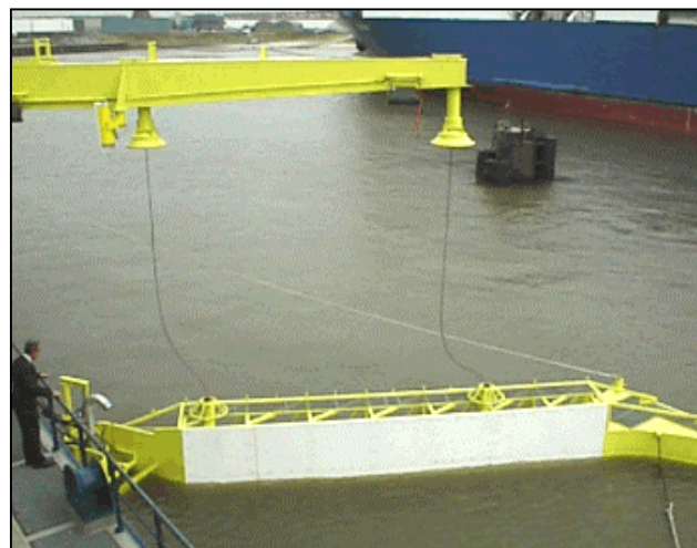
Figuur 7.17 Het ms Arca uitgerust met een speciale hijskraan waarmee men op zee een veegarm uit kan zetten
