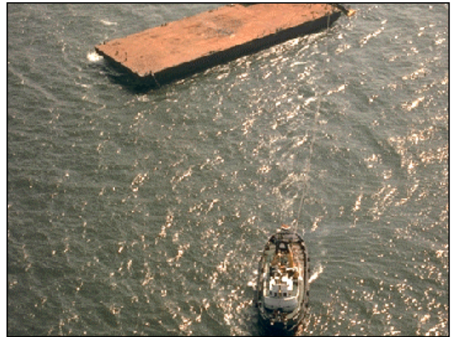
Figuur 7.7 Een zeegaand ponton kan ideaal in combinatie met een veegarm worden ingezet. Hierbij wordt optimaal aan de opslagcapaciteit eis als aan de veegbreedte eis voldaan
