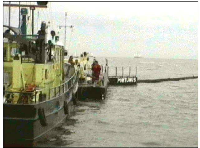
Figuur 7.15 De veegbreedte van de Portunus is vergroot m.b.v. oliekerend-scherm
