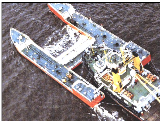
Figuur 7.10 Het Duitse vaartuig Westensee met het MOD systeem (Mobiele Oil Dike)
