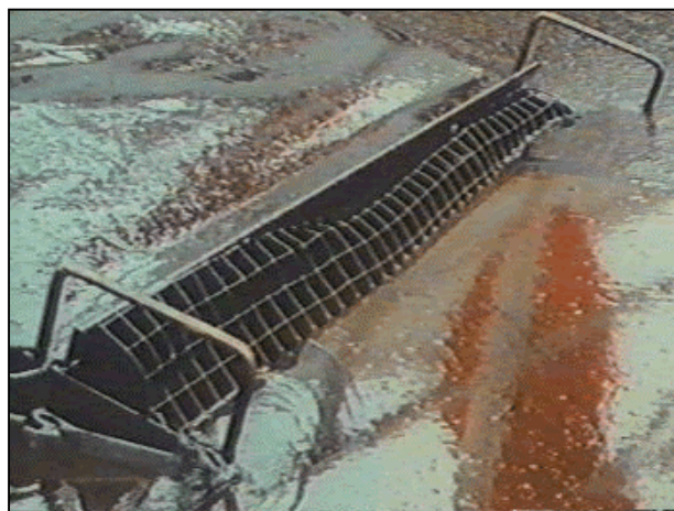
Figuur 6.1 Drijvende olielaag kan eenvoudig worden afgeroomd met een skimmer
