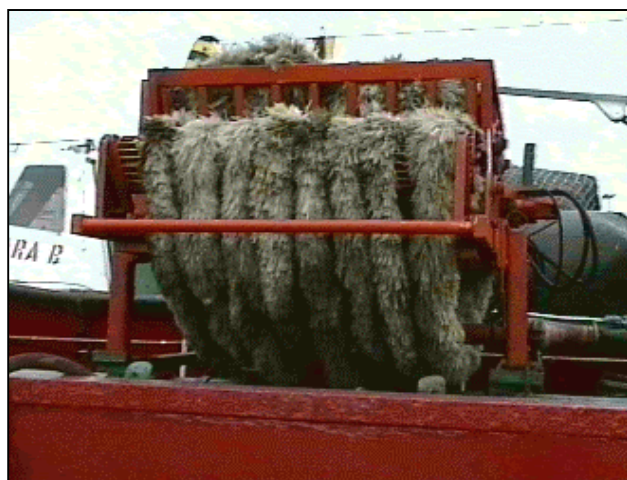
Figuur 6.7 Wringer waarmee de olie weer uit de Oilmop wordt gewrongen
