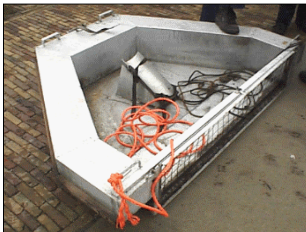
Figuur 6.3 De Roteb 1500 skimmer is de meest toegepaste skimmer in Nederland
