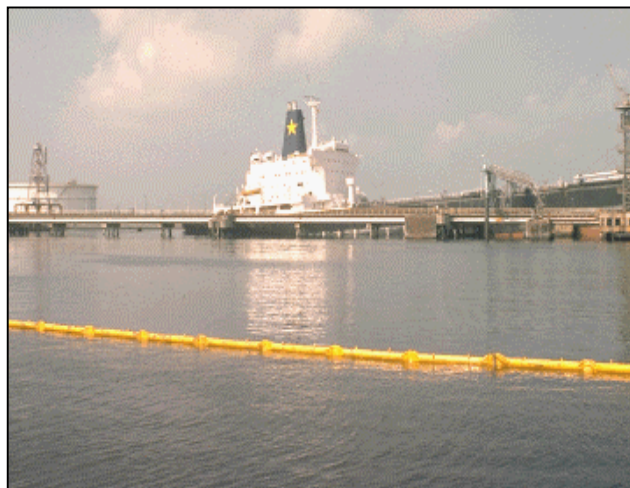
Figuur 5.1 Met een oliekerend scherm kan de verspreiding van olie op het water worden tegengegaan
