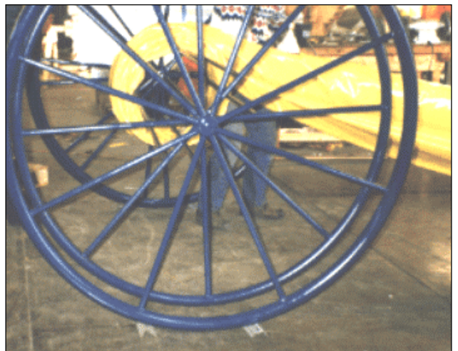
Figuur 5.14 Het wiel in wiel systeem is een zeer handig opbergsysteem voor luchtgevulde oliekerende schermen
