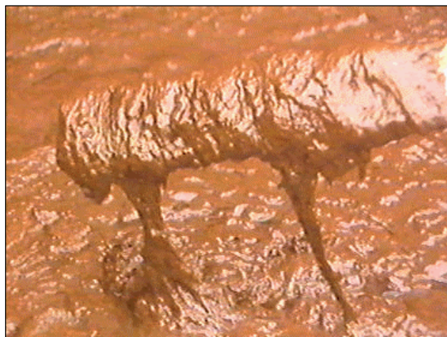
Figuur 11.12 Resultaat na behandeling met het geleringsmiddel “Rigidoil”
