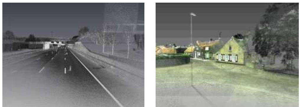
Fig 3 A (links): Een laserpuntenwolk van de omgeving van een snelweg. Elk punt representeert een nauwkeurige XYZ waarneming. Fig 3B (rechts): Door gebruik van de videocamera's kan aan elk XYZ waarneming een RGB kleur worden gegeven zodat er een goed beeld ontstaat waar de punten zijn gelocaliseerd.
